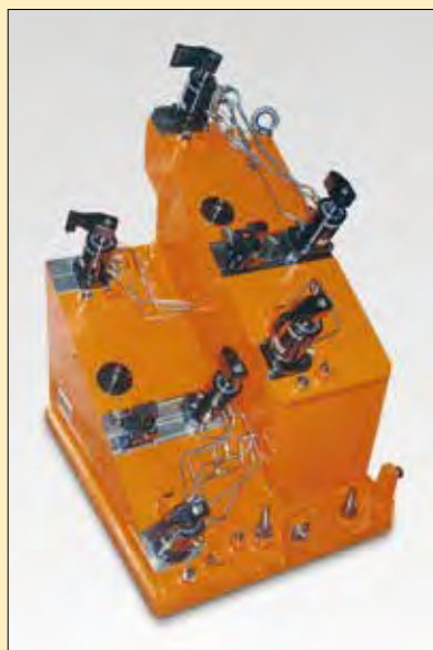
■ Dispositivo di serraggio per la lavorazione di collettori di scarico.
