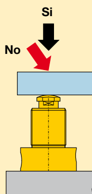
Figura 2 La direzione della forza di bloccaggio deve essere assiale e passare per il centro del pistone del supporto affinché si abbiano i migliori risultati nel bloccaggio e nella ripetibilità della qualità.
